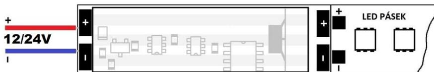
Pro napájení použijte výhradně stabilizované napájecí zdroje určené pro LED pásy nebo alespoň spínané stabilizované zdroje pro komerční použití.
